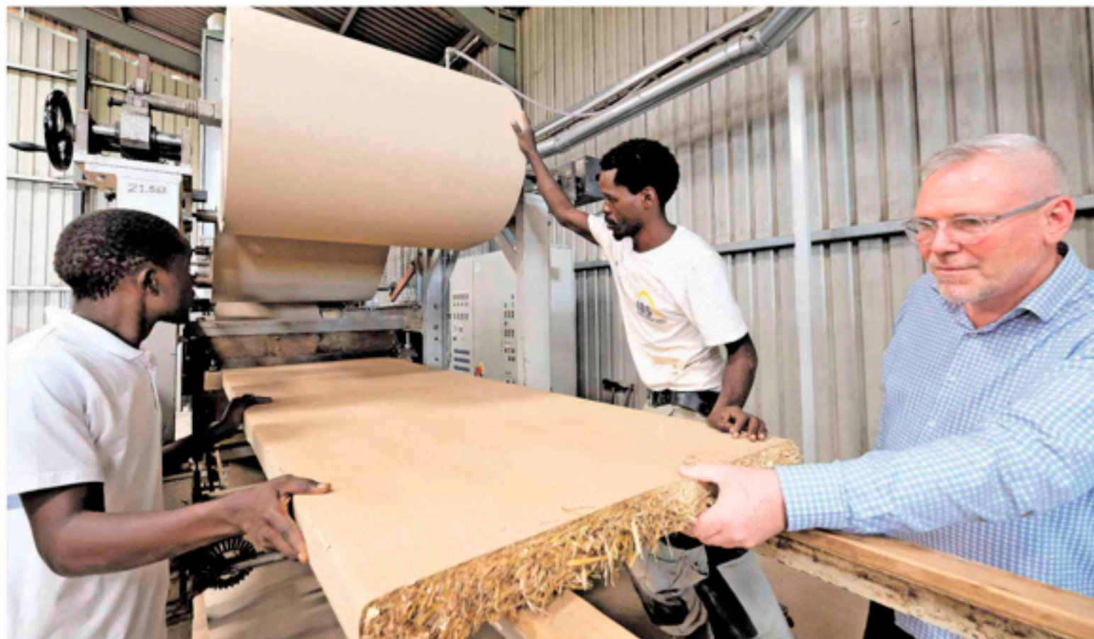
Hält Hitze und Kälte ab: Aus zu Paneelen verarbeitetem Reisstroh baut Eckardt Dauck Decken und Wände für Häuser. Foto Peter Pauls
